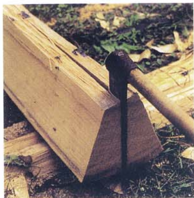
(図3)オーク材の裁断 木材の中心から放射状に割っていくことで、柱目板がたくさん作られる。
